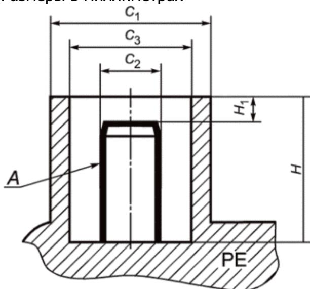
$A$  - рабочая часть;  $C_1$  - наружный диаметр защитной втулки,  $C_1 = (13,00 \pm 0,5)$ ;  $C_2$  - диаметр рабочей части клеммы,  $C_2 = (4,70 \pm 0,1)$ ;  $C_3$  - внутренний диаметр защитной втулки,  $C_3 = 10,0_{+0,5}^{-0,1}$ ;  $H$  - внутренняя глубина защитной втулки,  $H \geq 15,5$ ;  $H_1$  -
