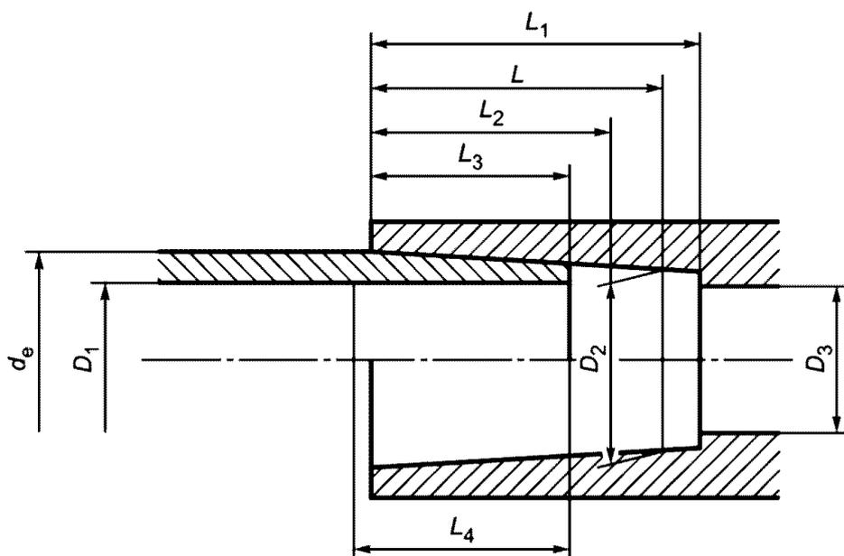
$D_1$  - средний внутренний диаметр входного отверстия раструба, т.е. средний диаметр окружности расширяющейся части раструба на пересечении с плоскостью входного отверстия раструба;
