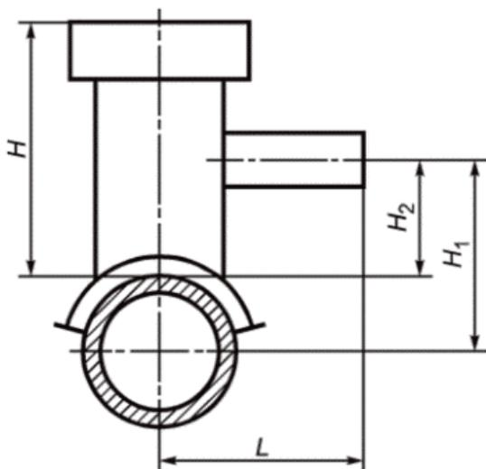
$H$  - высота седлового отвода, включающая расстояние от наружной поверхности трубы до верхней плоскости Т-образного или седлового отвода;  $H_1$  - высота бокового отводного патрубка, включающая расстояние между осью трубы и осью отводного патрубка;  $H_2$  - высота бокового отводного патрубка, включающая расстояние от наружной поверхности трубы до оси отводного патрубка;  $L$  - длина вылета бокового отводного патрубка, включающая расстояние между осью трубы и торцом отводного патрубка
