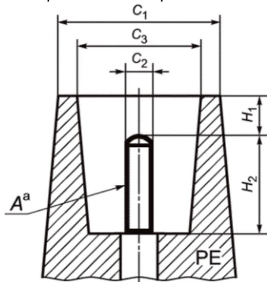
$A$  - рабочая часть;  $C_1$  - наружный диаметр защитной втулки,  $C_1 \geq (C_3 \pm 2,0)$ ;  $C_2$  - диаметр рабочей части клеммы,  $C_2 \geq (2,0 \pm 0,1)$ ;  $H_1$  - расстояние между торцом защитной втулки и рабочей частью клеммы,  $H_1$  должно быть достаточным, чтобы обеспечить степень защиты IP 2X (см. [11]);
