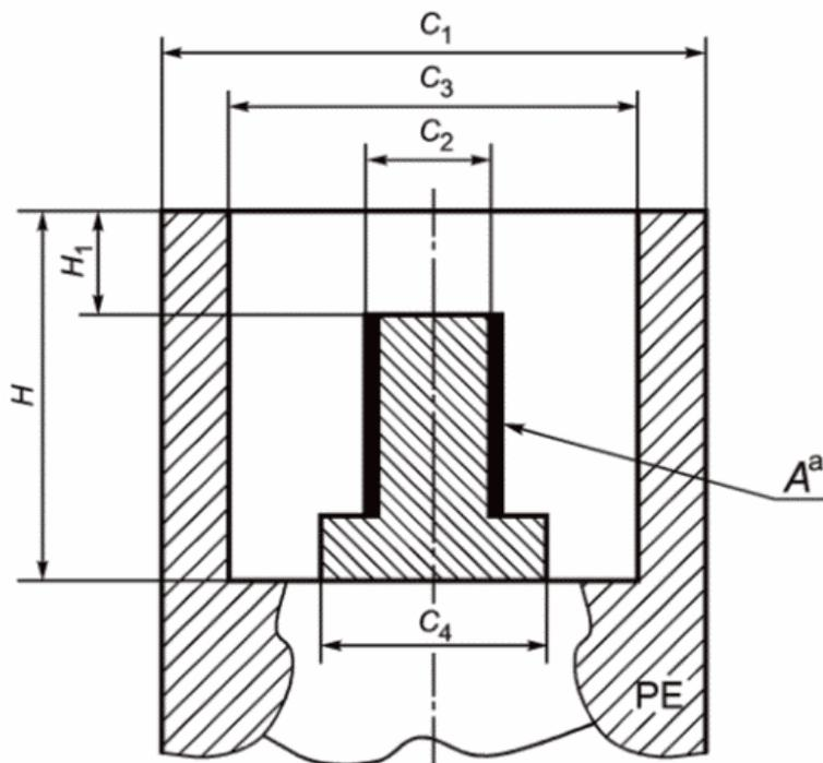
$A$  - рабочая часть;  $C_1$  - наружный диаметр защитной втулки,  $C_1 \geq 11,8$ ;  $C_2$  - диаметр рабочей части клеммы,  $C_2 = (4,00 \pm 0,1)$ ;  $C_3$  - внутренний диаметр защитной втулки,  $C_3 = (9,5 \pm 1,0)$ ;  $C_4$  - максимальный габаритный диаметр в основании клеммы,  $C_4 \leq 6,0$ ;  $H$  - внутренняя глубина защитной втулки,  $H \geq 12,0$ ;  $H_1$  - расстояние между торцом защитной втулки и рабочей частью клеммы,  $H_1 = (3,2 \pm 0,5)$ ;
